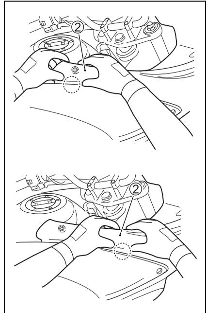
10. Die Kraftstofftankabdeckung ist an den Rechteckmarkierungen hinter der Abdeckung mit Befestigungsteilen versehen.
