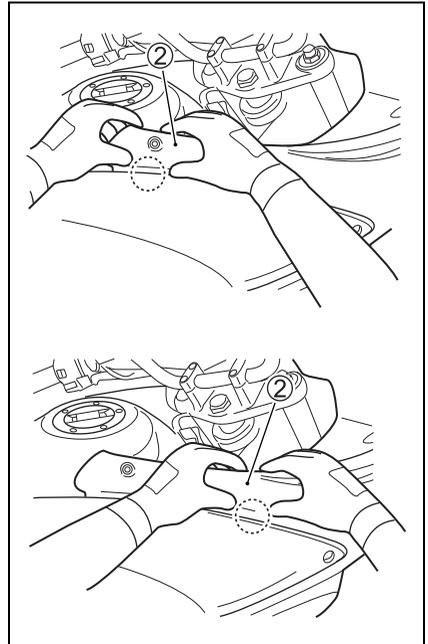
10. Le cache du réservoir de carburant est fixé par des attaches derrière le cache aux endroits marqués par un rectangle. Tirer sur les caches latéraux du réservoir de carburant ④ pour détacher les crochets.
